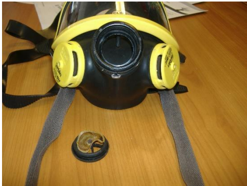
Uitlaatventiel dat niet meer afsluit.
