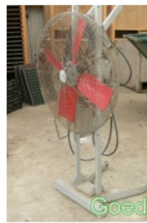
Goed afgeschermd ventilator
