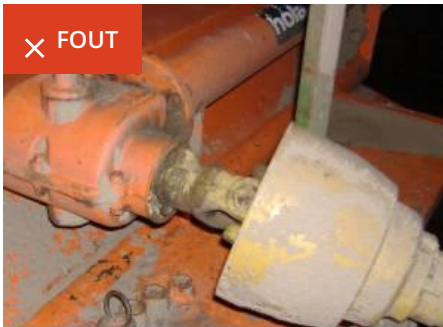
Kap werktuigzijde ontbreekt
