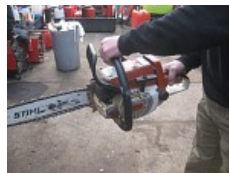
Foto: Normale motorkettingzaag met tweehandenbediening
