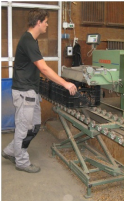
Afb.: Schaartafel (traploos in hoogte verstelbaar)
