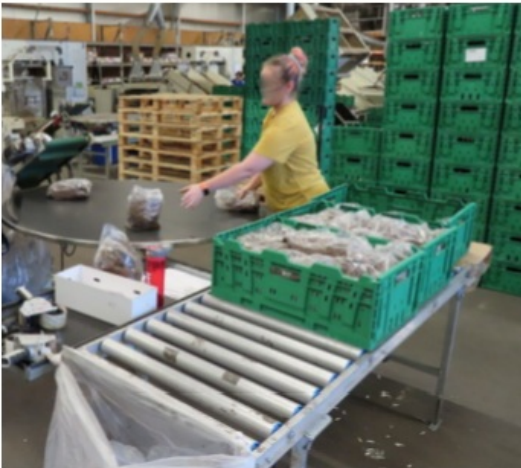
Afb.: Draaischijf als buffer na afvoerband en rollerbanen
