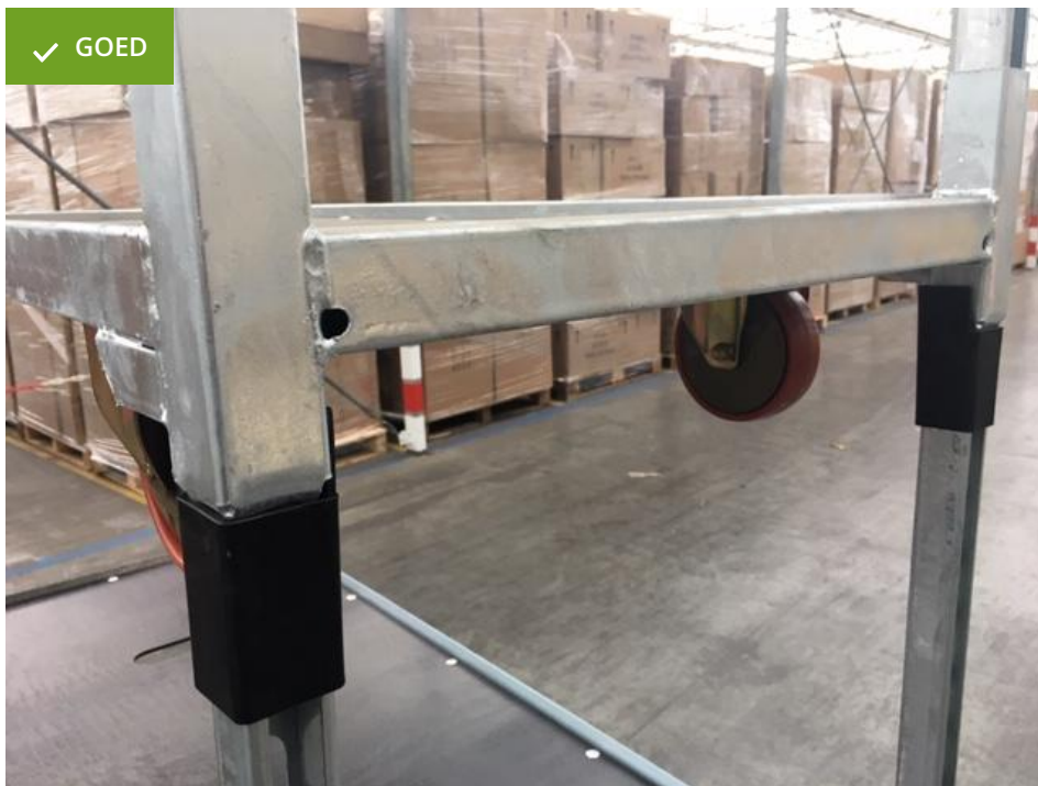
Halve Deense karren stapelen met stapelblokken.
