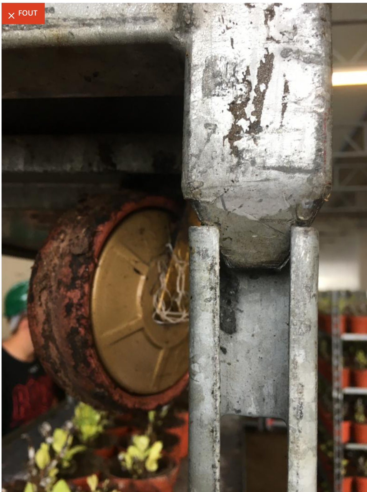
Halve Deense karren stapelen zonder stapelblokken.
