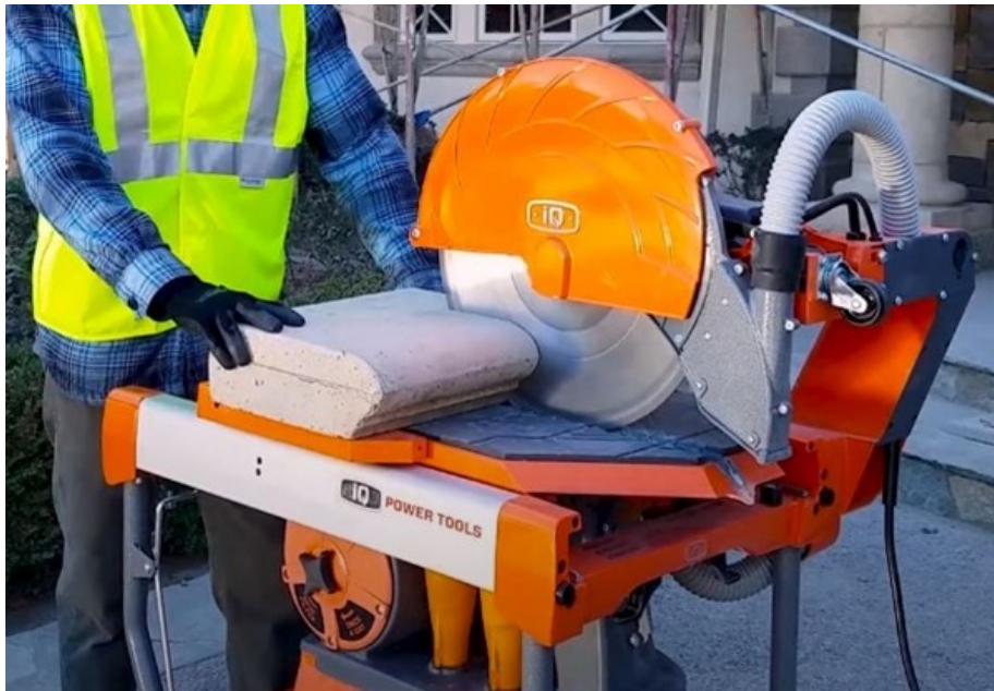
Afbeelding 2; zaagtafel met bronafzuiging
