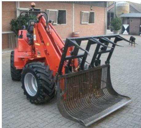
Uitschuifbare tussenwand, hier nog niet volledig uitgetrokken
